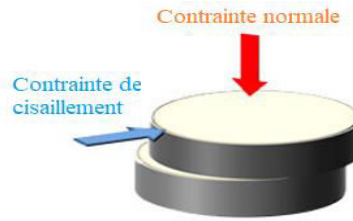
Figure 3 : Principe de fonctionnement de la cellule de Jenike composée d'un demi-cylindre inférieur fixe et un demi-cylindre supérieur mobile [25].
