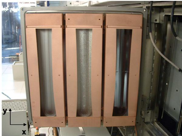
Figure 5 : Photographie des cibles recouvertes de caches d'uniformité en cuivre.
