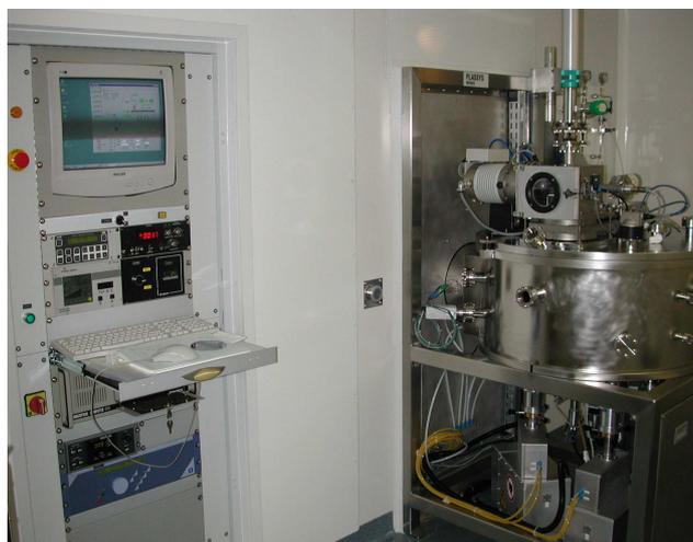
Figure 1 : Photographie du système de dépôt MP800S
