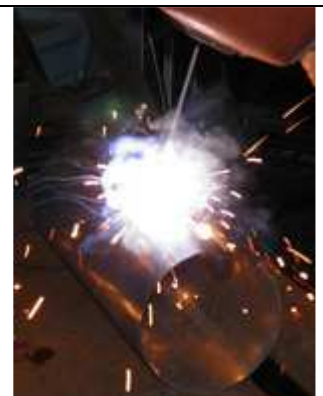
32. Soudure pour refermer le tube.
