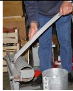
35. Pliage de la collerette (avec la rouleuse).
