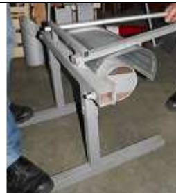
27. Suite, pliage de la tôle avec la rouleuse, en s'aidant, cette fois-ci, de 2 barres parallèles (qui permettent de tordre plus la tôle).
