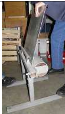
26. Pliage de la tôle avec la rouleuse manuelle
