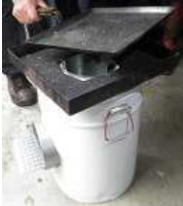
1. CBE (cuiseur bois économe) avec adaptateur pour grillade
