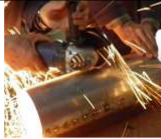
38. Découpage de la tôle du tube, en oblique à 45°, avec une scie circulaire, selon le tracé de l'outil lapidaire.
