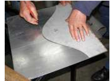
24. Dessin de la courbe en cloche avec le lapidaire, en utilisant et en suivant la courbe en cloche du gabarit.
