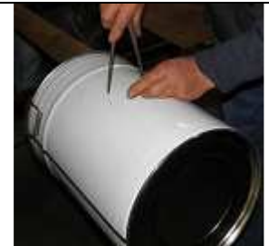
44. Traçage cercle, au compas, sur le bidon.
