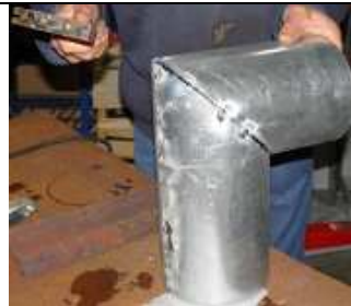
42. Fin de la soudure du coude du tuyau
