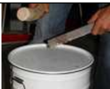
45. Exemple, d'une façon de découper un trou circulaire sur le couvercle.
