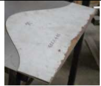
23. Gabarit [ayant un peu la forme d'une « courbe de Gauss »] obtenu par traçage et découpage.
