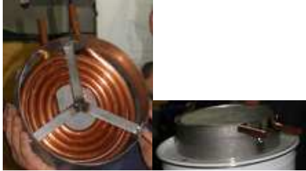
10.. 11. Accessoire type chauffe-eau pour CBE.
