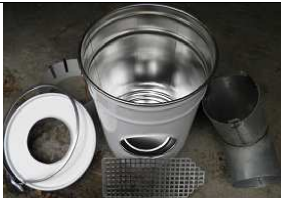
6.. Décomposition d'un CBE A gauche 1) le couvercle troué, 2) derrière la collette avec ses pinces, au centre 3) le bidon troué, 4) la grille, 3) à droite, la cheminée en acier soudé (ou agrafé).
