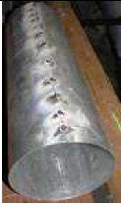
33. Points de soudure sur le tube.
