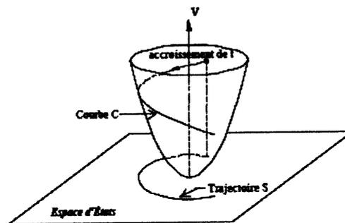
Figure II.5. Fonction de Lyapunov pour un système autonome.
