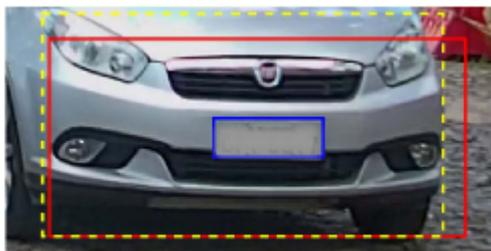
FIGURE 3.7: Plaque détectée par YOLO [34]
