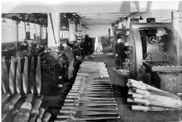
Figure 11- Atelier à Kellermann : fabrication des hélices 42
