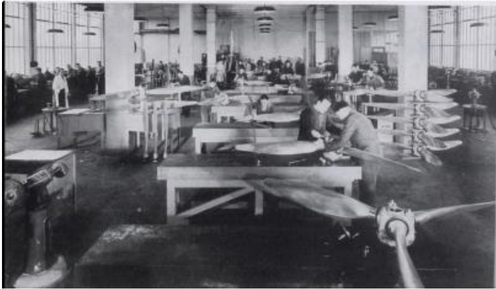
Figure 12- Contrôle des hélices 43
