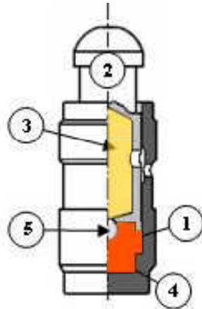
Le ressort ( **1** ) déplace le piston mobile ( **2** ) qui maintient le linguet au contact de l'arbre à cames. L'huile sous pression remplit la chambre ( **3** ).
