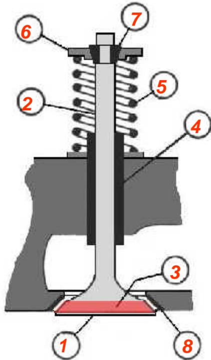
Elles permettent l'entrée et la sortie des gaz tout en assurant une bonne étanchéité pendant les temps compression et inflammation détente.
