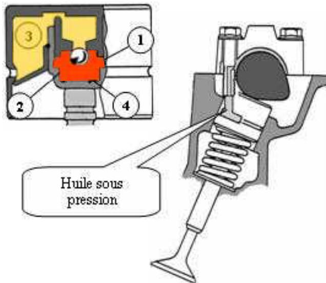
Quand la soupape est fermée, le ressort ( 1 ) maintien un contact permanent du poussoir sur la came. L'huile sous pression remplis la chambre ( 3 ).
