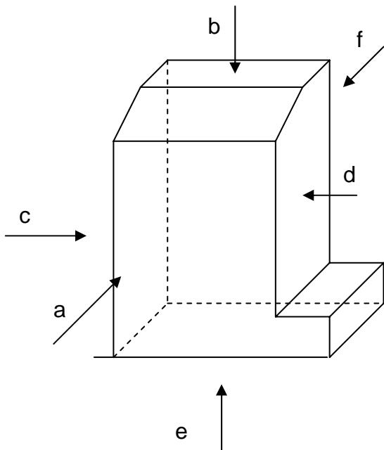
Après le choix de la **vue de face**, qui est la vue la plus caractéristique, on obtient les autres vues par rotation de la vue de face de – **un quart de tour** – :
