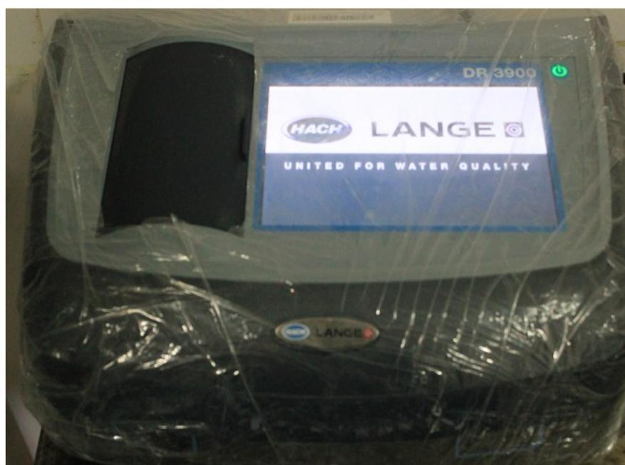
**Spectrophotomètre RFID (Radio frequency identification) de marque
