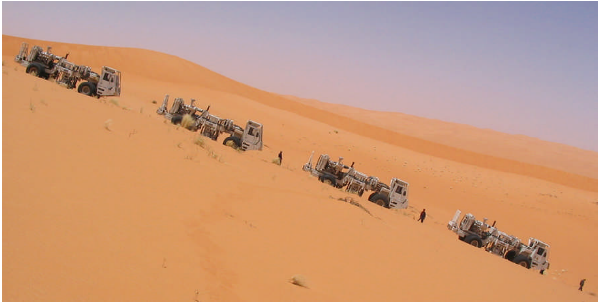
Figure 5.4. Positionnement des vibrateurs dans la ligne source.
