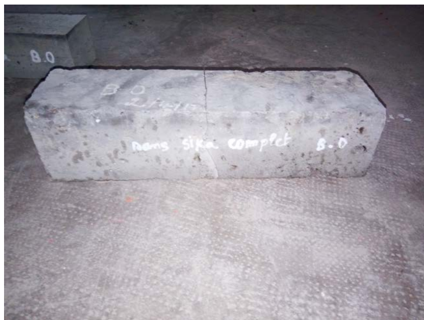
Figure IV.32: B.O sans reprise de bétonnage.
