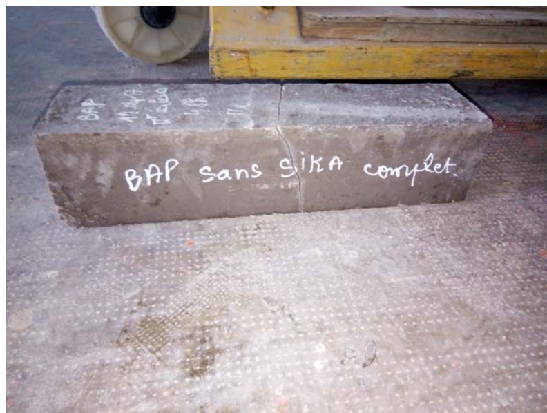
Figure IV.35: BAP sans reprise de bétonnage.
