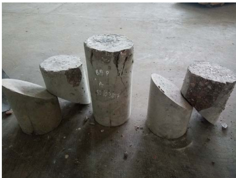
Figure IV.28: BAP avec une surface inclinée avec Sika.
