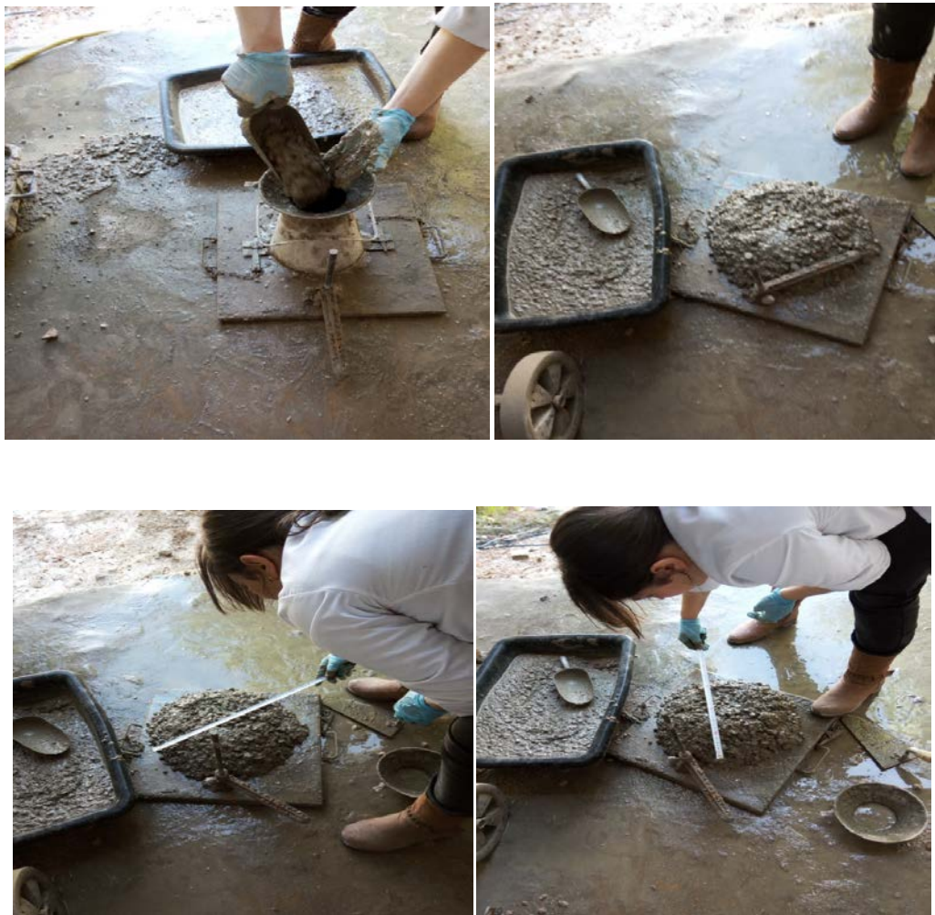
Figure IV.10: Essai d'étalement au cône d'abrams pour BAP.
