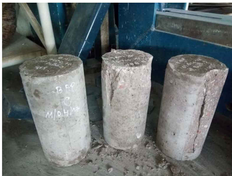
Figure IV.29: BAP sans reprise de bétonnage.
