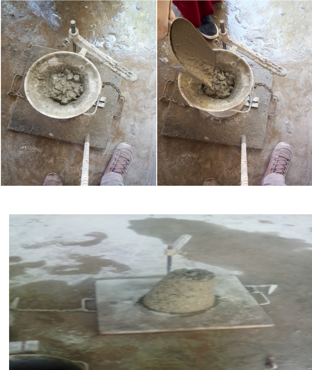
Figure IV.9: Essai d'affaissement au cône d'abrams.
