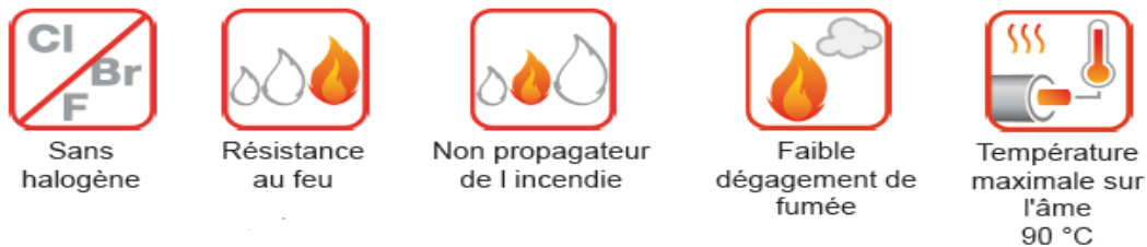
Figure III.23. Caractéristiques des câbles électriques
