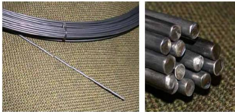
Photo 2.3 : AMF à base de « Ni-Ti »
