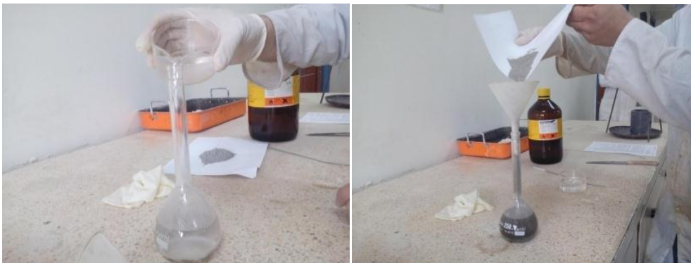
Figure 3. 1 : Essai de la masse volumique absolue (photos prises par les auteurs)
