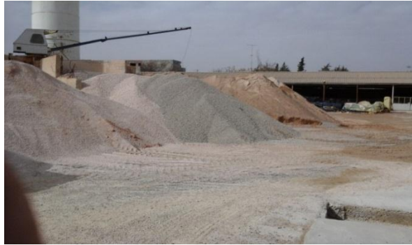
Figure 2. 32 : Le stockage des granulats à l'air libre (photo prise par les auteurs)
