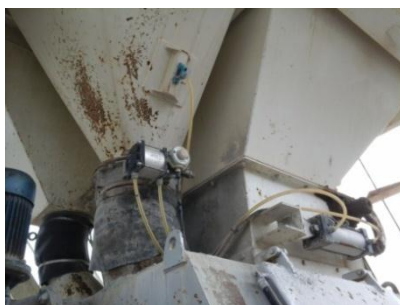
Figure 2. 23 : Les box de l'adjuvant, l'eau et le ciment (photo prise par les auteurs)
