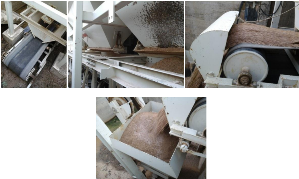
Figure 2. 21 : Le transport des granulats vers le skip (photos prises par les auteurs)
