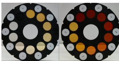
Figure 5.8 : Disques étalon colorés et numérotés selon la norme ASTM D1544.
