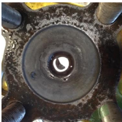
Figure 6.30 : Représentation du gâteau formé lors de l'essai de filtration à pression constante
