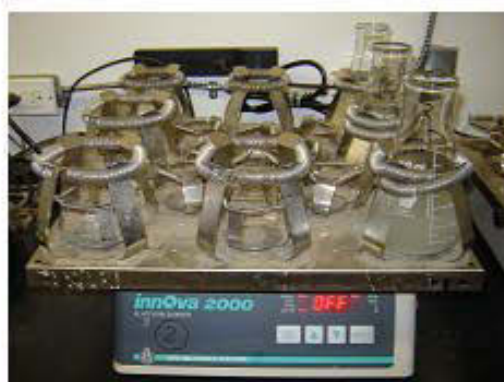
Figure 3-7: Photographie des essais de sorption agités
