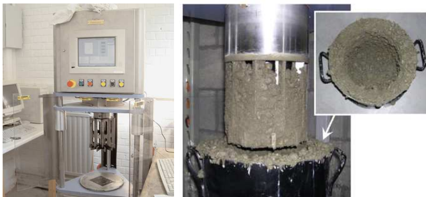
Figure 1.11 : (a) Rhéomètre BML ConTec Viscometer 5. (Wallevik et al. , 1990) (b) Effet de migration des particules à l'intérieur du rhéomètre de ConTec Visco5 (Heirman et al. , 2009)
