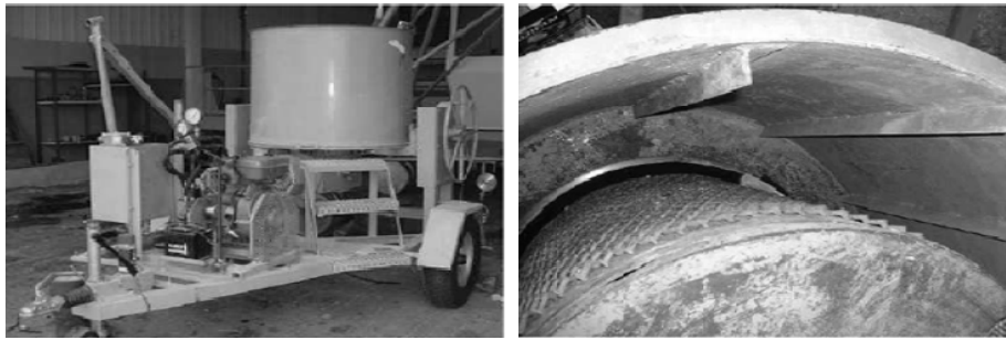
Figure 1.12 : (a) CEMAGREF –IMG, (b) cylindres intérieur et extérieur (Banfill, 2000).
