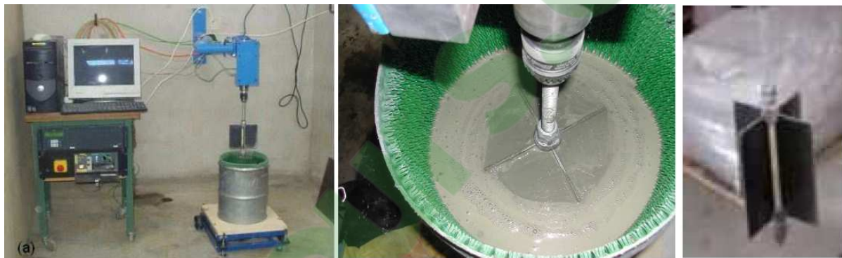
Figure 1.17 : Géométrie vane du rhéomètre LGCGM (Estellé et al., 2008)
