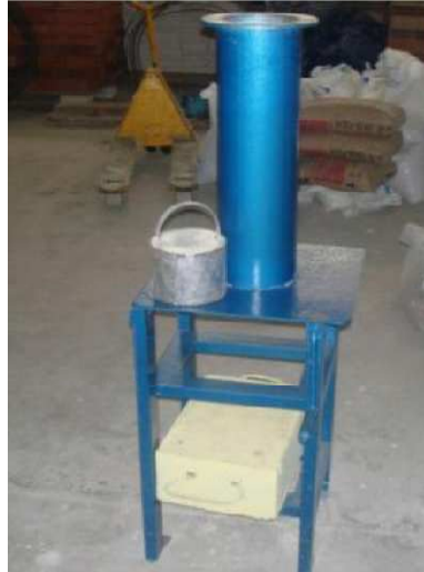
Figure 4.7: Banc d'essai pour déterminer la compacité des granulats.
