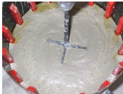
Figure 5.2 : Mise en place de la pale dans le mélange.
