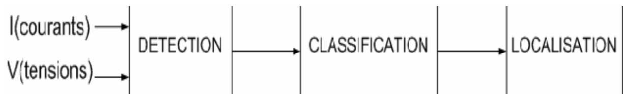
Figure V.2 Schéma bloc des méthodes utilisées dans l'analyse des défauts
