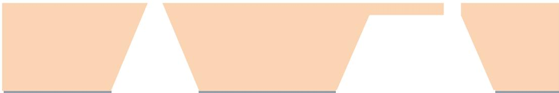
14. Assemblage de la structure (3) et (9) par soudure verre silicium
