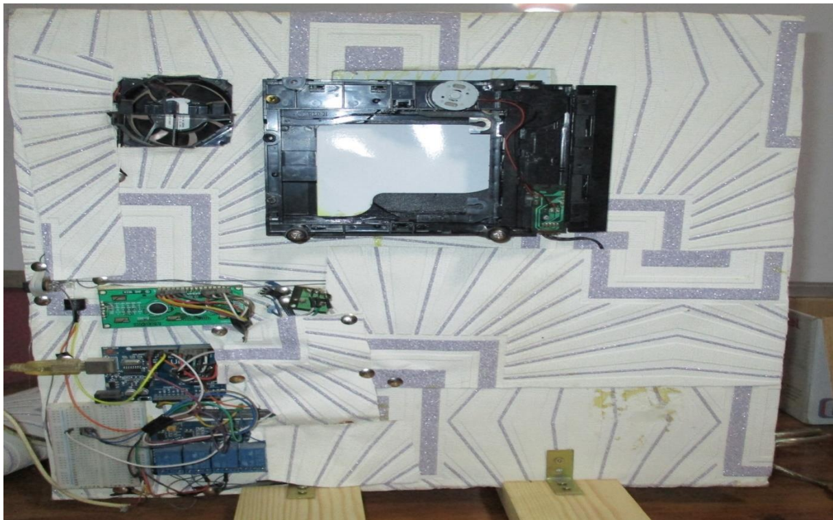
Figure III.16 : Prototype de détection de gaz "la face arrière".
