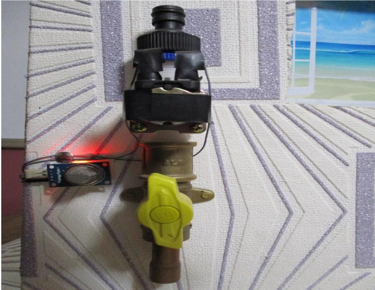
Figure III.12 : Bloc d'action automatique "électrovanne".
