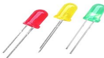
Figure II.16 : Diodes électroluminescentes (Rouge, Jaune, Vert) [19].
