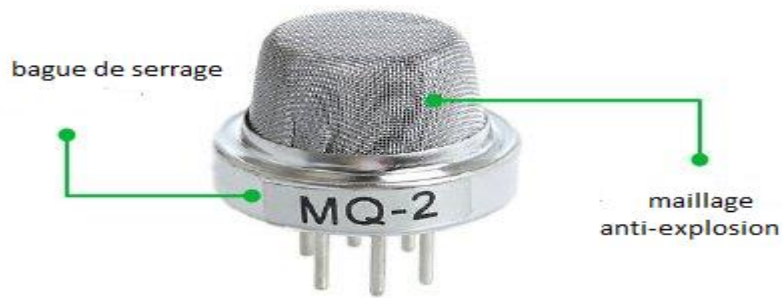
Figure II.8 : La structure extérieure de MQ-2 [17].
