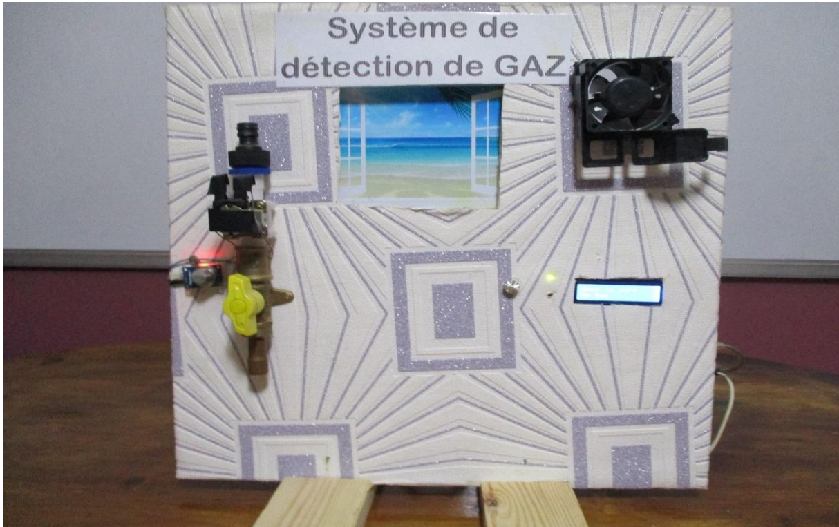
Figure III.15 : Prototype de détection de gaz "la face avant".
