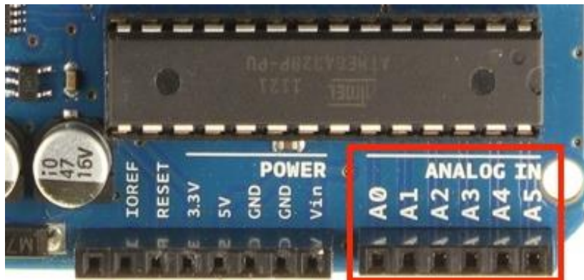
Figure II.5 : Broches d'entrées Analogiques [16].
