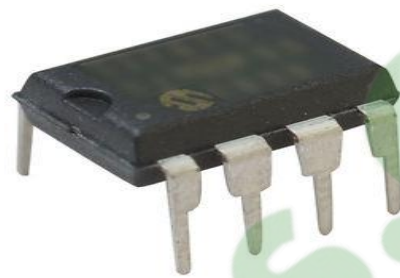
Figure -2.12- Exemple d'amplificateur opérationnel
