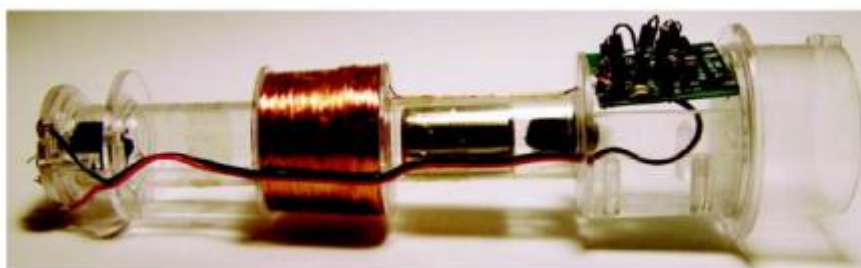
Figure 1.4 Lampe torche utilisant un générateur électromagnétique [3].
