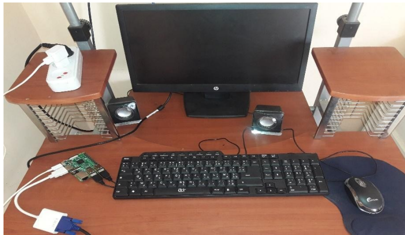
Figure II.21 : Le branchement de Raspberry avec tous les accessoires
