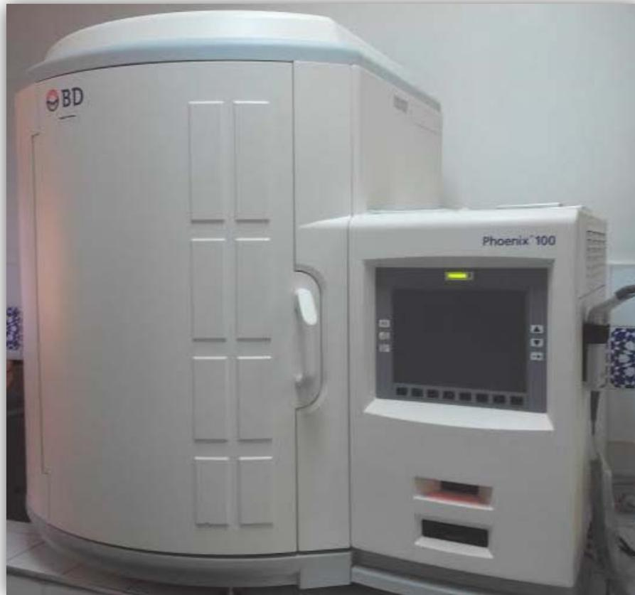
**Figure 2: Le Phoenix 100 de Becton Dickinson est l'automate d'analyse utilisé en routine au laboratoire de l'HMA**
