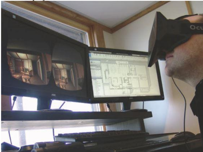
Photo. Lunette de réalité virtuelle permettant de plonger dans le modèle BIM (source Oculus VR)
