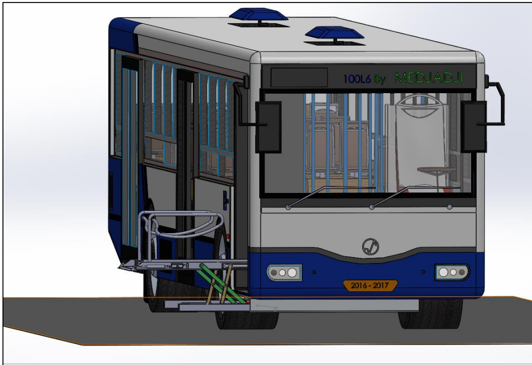
Figure IV.69 : Plate-forme installée à l'autobus – position plancher -
