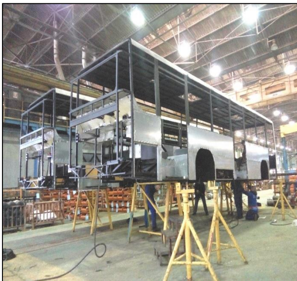
Figure III.12 - Autobus 100L6 lors de premier parcours de fabrication
