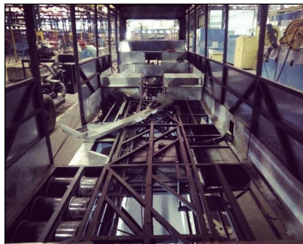
Figure IV.15 : Architecture interne du bus - vue d'intérieur -
