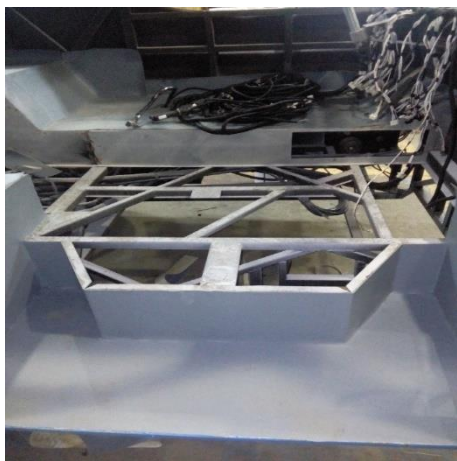
Figure IV.10 : Encombrement sous plancher – Porte Avant -
