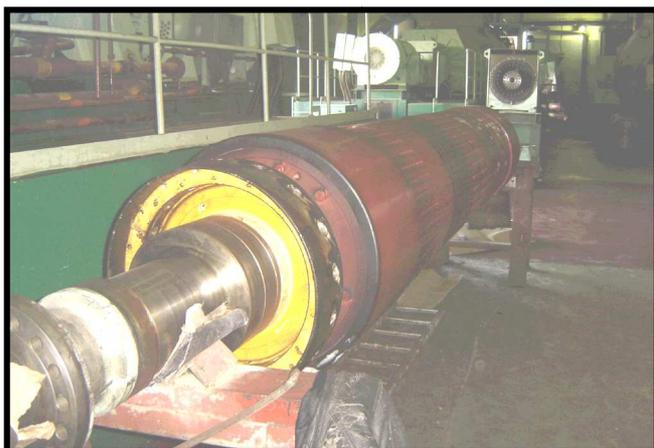
*Figure I.5 : Rotor à pôle lisse d'un alternateur de la centrale de Bab Ezzouar*
