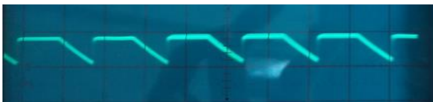
Figure 3.20 : Signal de sortie du IC4 (broche 1,2).
