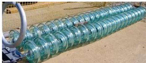
**Figure I-10 : une chaîne d'isolateur.**
