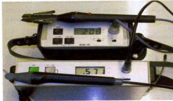
Fig. II.1 : Photo d'un conductimètre à sonde mobile
