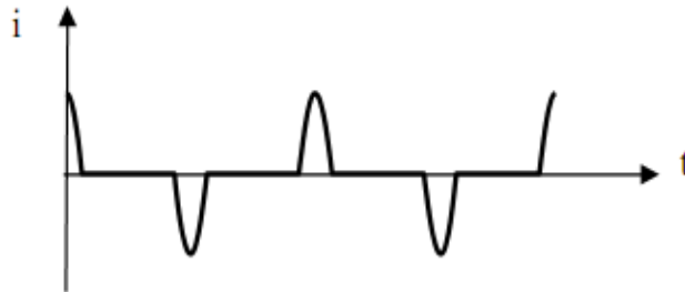
Figure I-6 : Alimentation à découpage dans un micro-ordinateur
