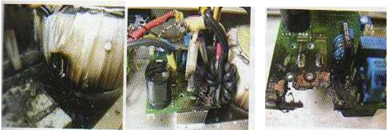
Fig. IV.4: Surtension dans un onduleur [15]
