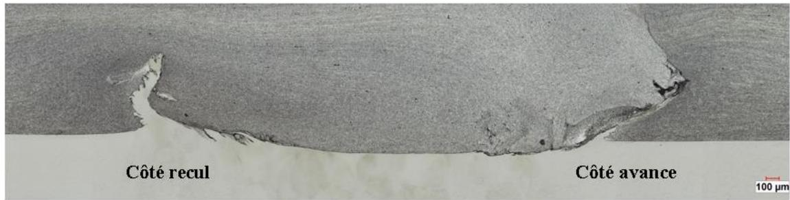
Figure 4.4: Mosaïque de la microstructure de la soudure AA5083 SPF/SS201LN à 50x, 1,25 m/min, 1500 RPM, 13 kN
