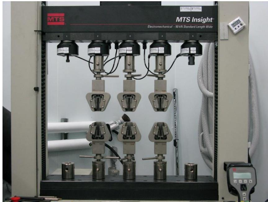
*Figure 3.11 : Appareil d'essai de traction statique MTS Insight 50W Multihead*
