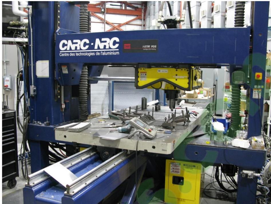
Figure 3.5: Soudeuse de type portique de marque MTS et de modèle I-Stir PDS
