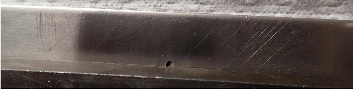
*Figure 4.12: Trou employé pour insérer le thermocouple dans la feuille d'acier*
