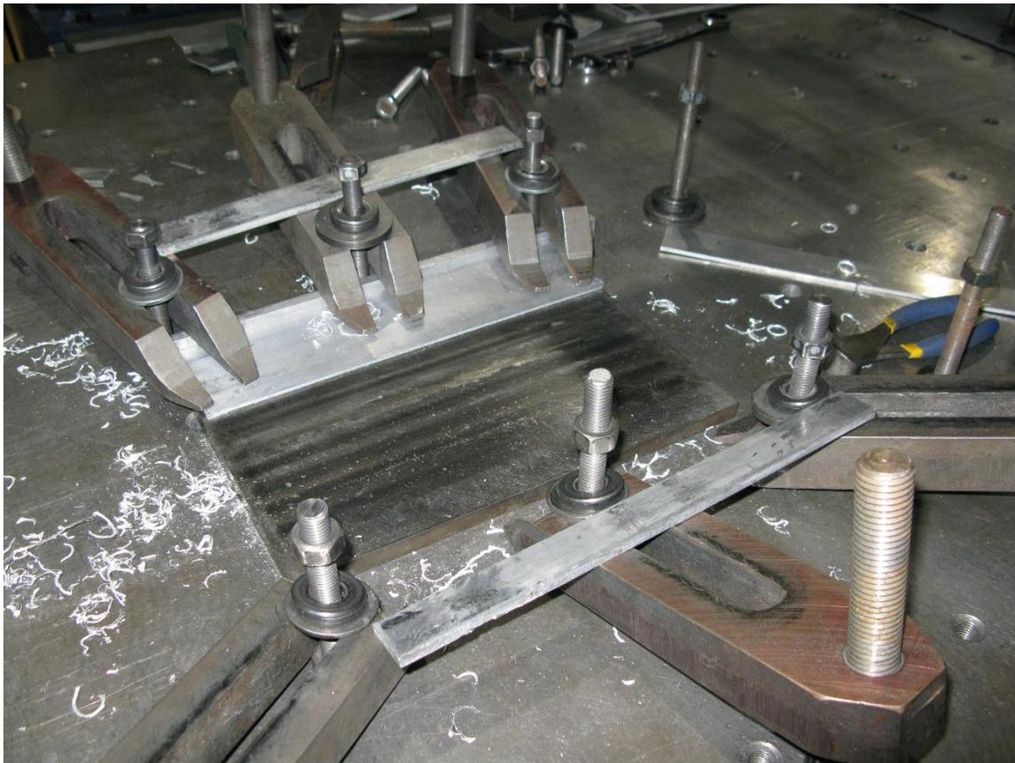
*Figure 3.9: Étaux et support envers utilisés pour fixer solidement les tôles à la table amovible*
