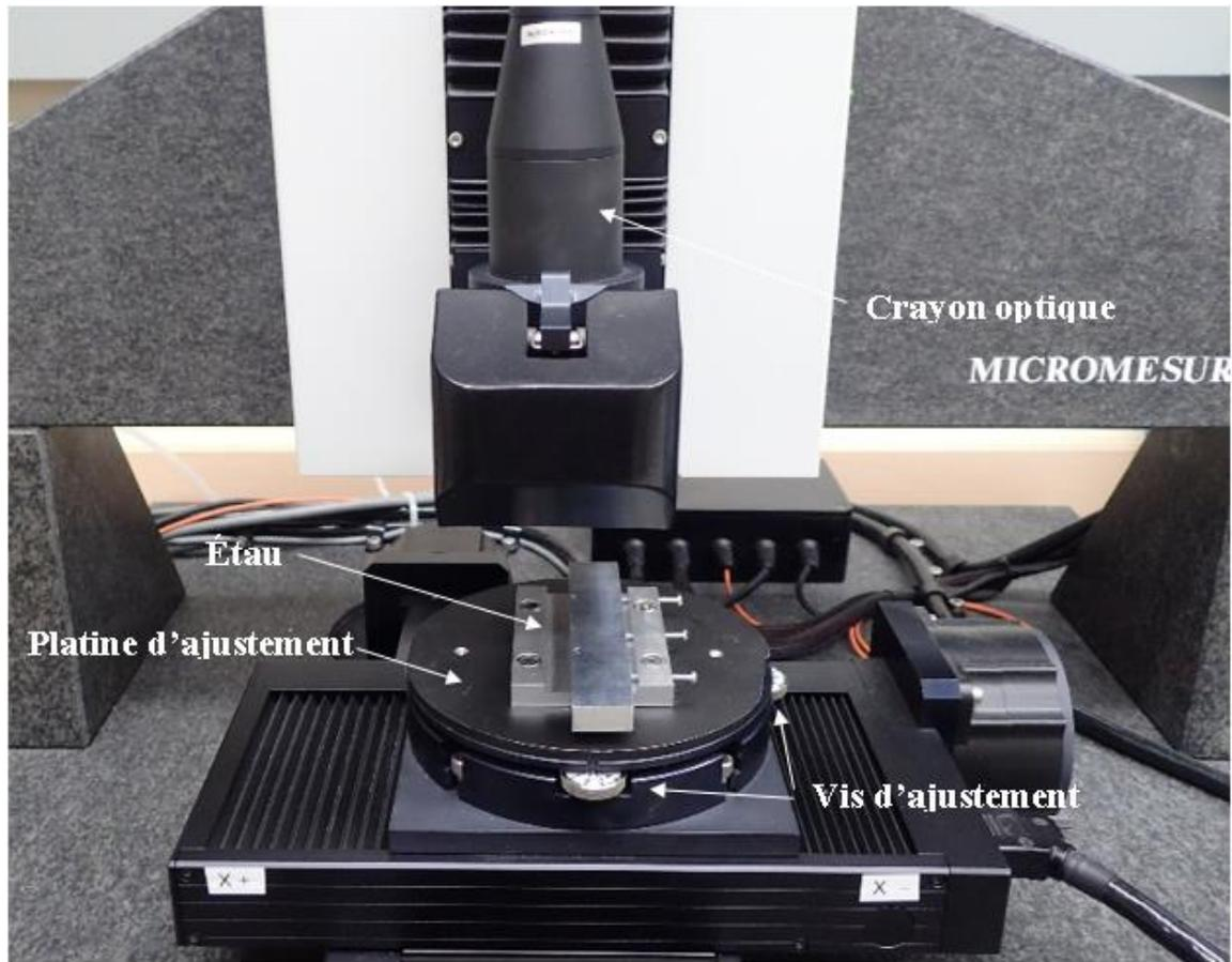
*Figure 3.17: Appareil de microtopographie 3D*
