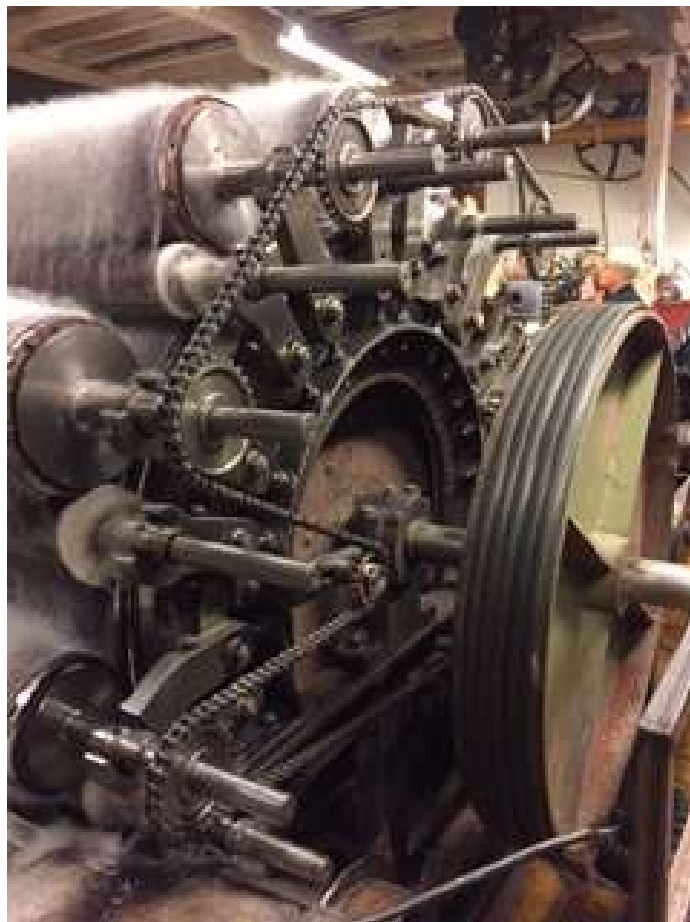
Figure 9 : Cardeuse à laine, Hillesvag Ullvarefarikk, Norvège Source : Collection personnelle, octobre 2018
