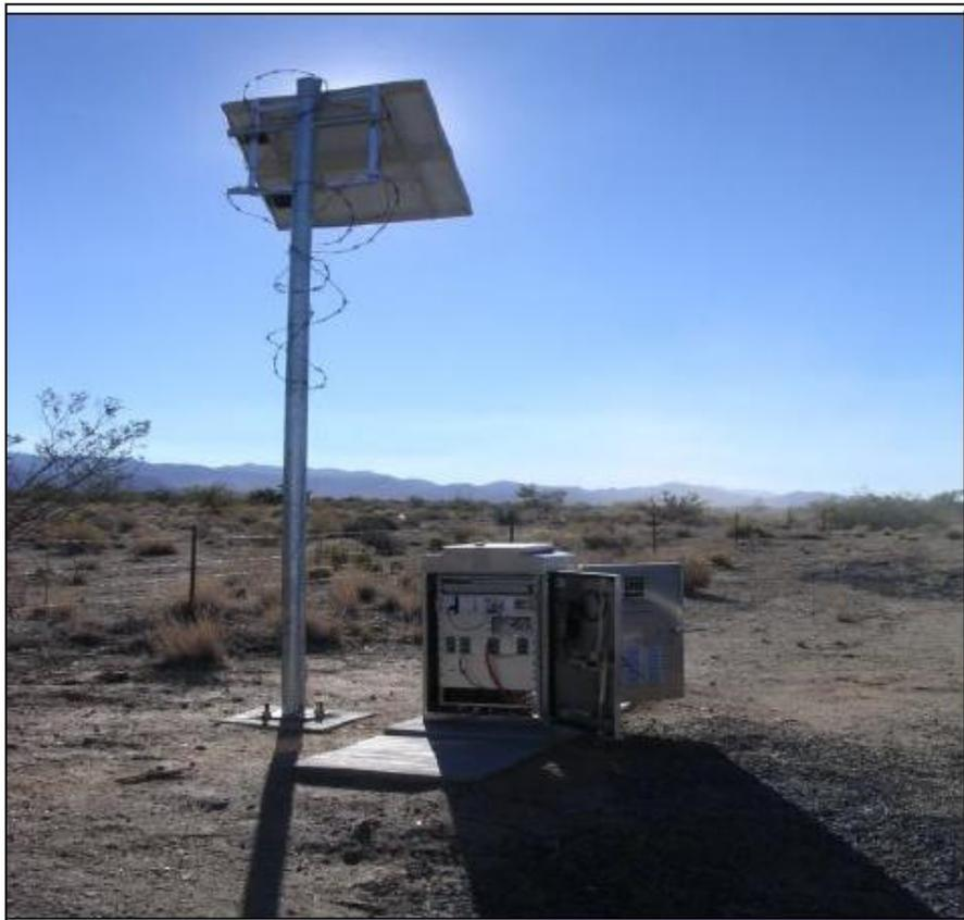
Figure 3.19 Fin de l'installation électrique; connexion des câbles au cabinet pour acquérir et transmettre les données (IRD, 2001)
