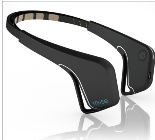
Figure 3.4 Instrument de mesure Muse Tiré de Interaxon inc. (2016, p. 4)
