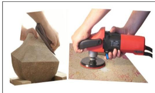
Figure 1-1: Polissage manuel du granit
