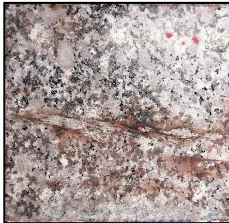
Figure : Brulure observée à la surface
