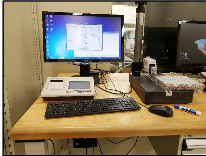
Figure 2-8: Profilomètre Mitutoyo
