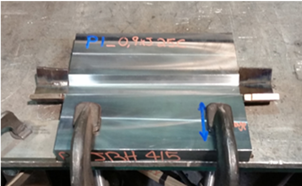
Figure 2.1 Plaque en acier S41500 rainurée avec appendices soudés aux extrémités de la rainure avant rechargement.
