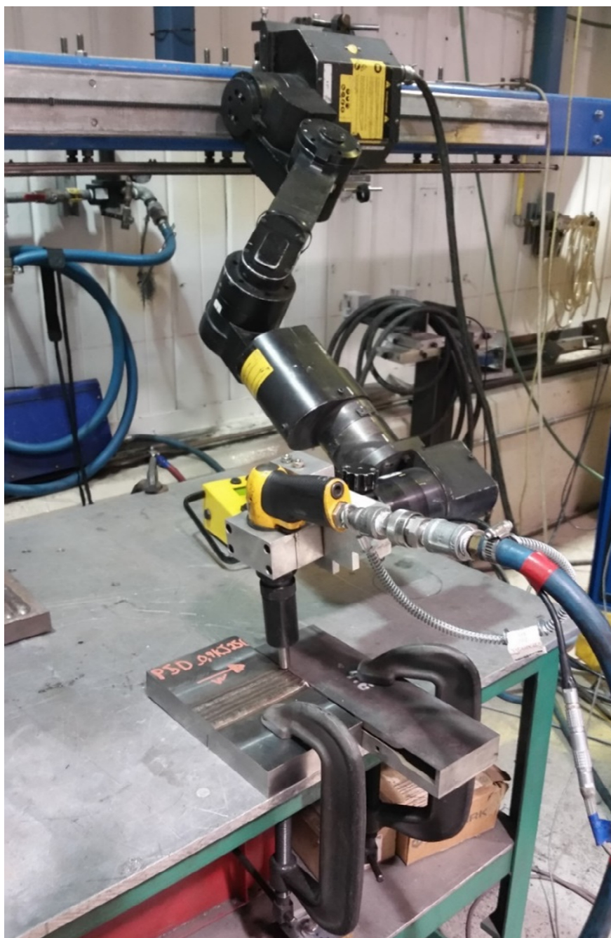
Figure 2.3 Montage pour l'opération de martelage
