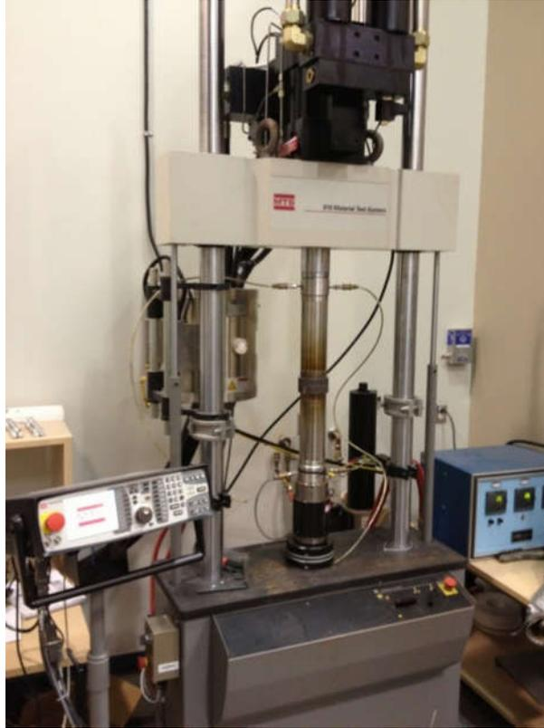
Figure 51. Presse hydraulique MTS-810
