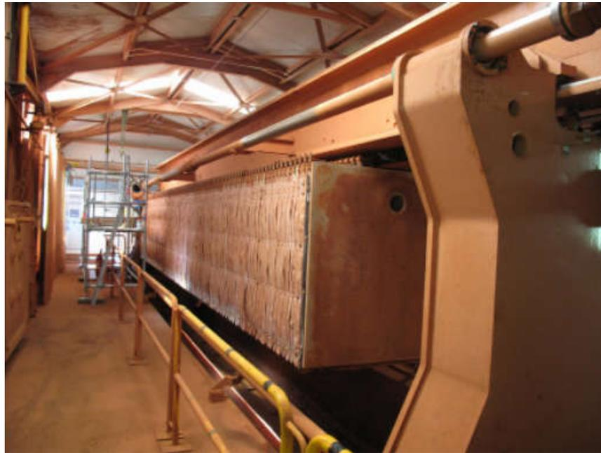
Figure 27. Filtre presse pour la filtration de la boue rouge à l'usine de Gardanne en France (European Aluminium 2015)
