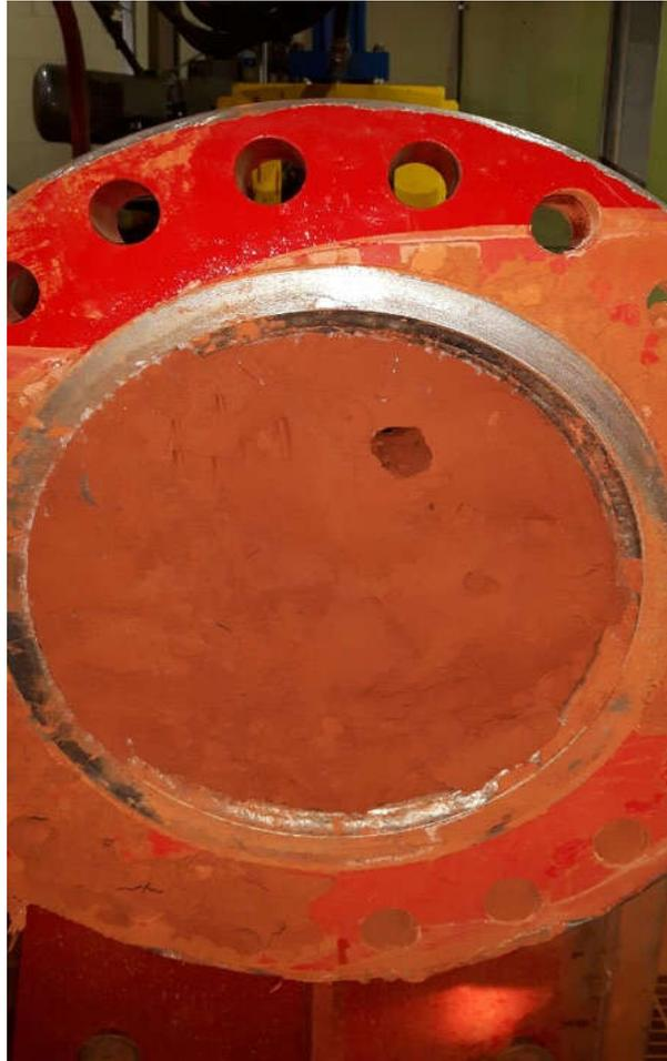
Figure 76. Photo du gâteau de boue compactée dans la section de sortie de la vis démontée après la seconde série de tests avec la presse à vis pilote
