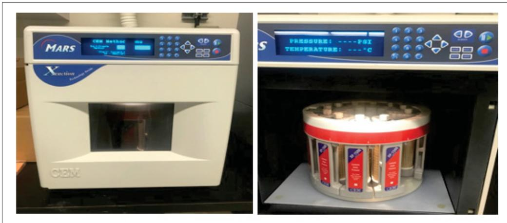
Figure 3.3 Micro-ondes utilisé pour la préparation des échantillons
