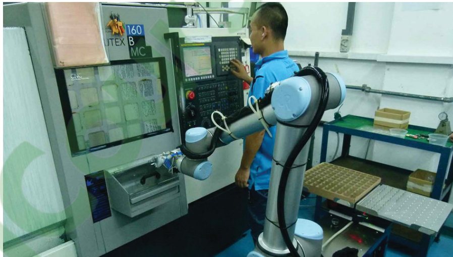
Figure 0.1 Utilisation typique d'un robot collaboratif, le service d'une CNC. Tirée de https://www.universal-robots.com/case-stories/plc-industries/
