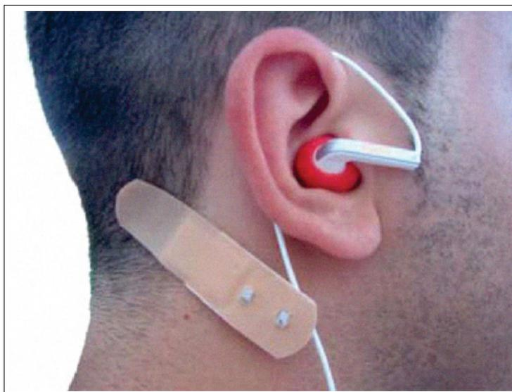
Figure 1.6 Microrécupérateur d'énergie thermique à proximité de l'oreille, tirée de Lay-Ekuakille *et al.* (2009)
