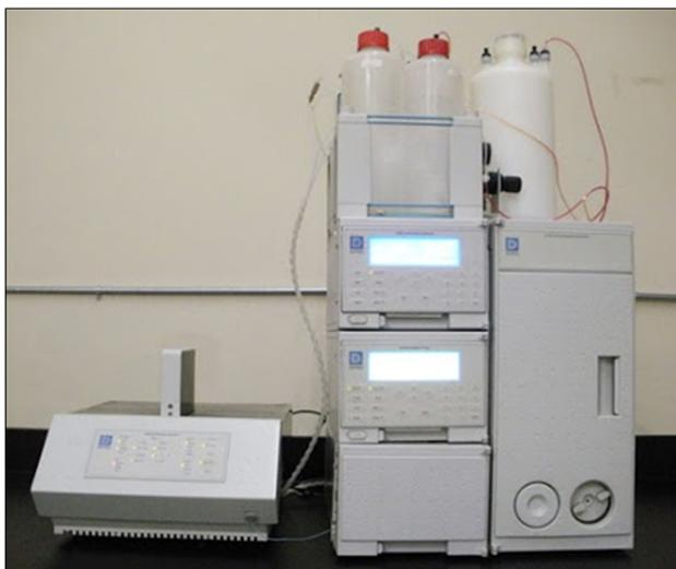
Figure 2.5 : Appareil de chromatographie ionique de marque Dionex
