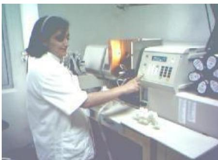
**Figure 77 :** Spectrophotomètre à Absorption Atomique à flamme A.Analyste 100 (Perkin Elmer)
