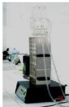
Figure 74 : Appareil de la minéralisation de type VELP muni de réfrigérants
