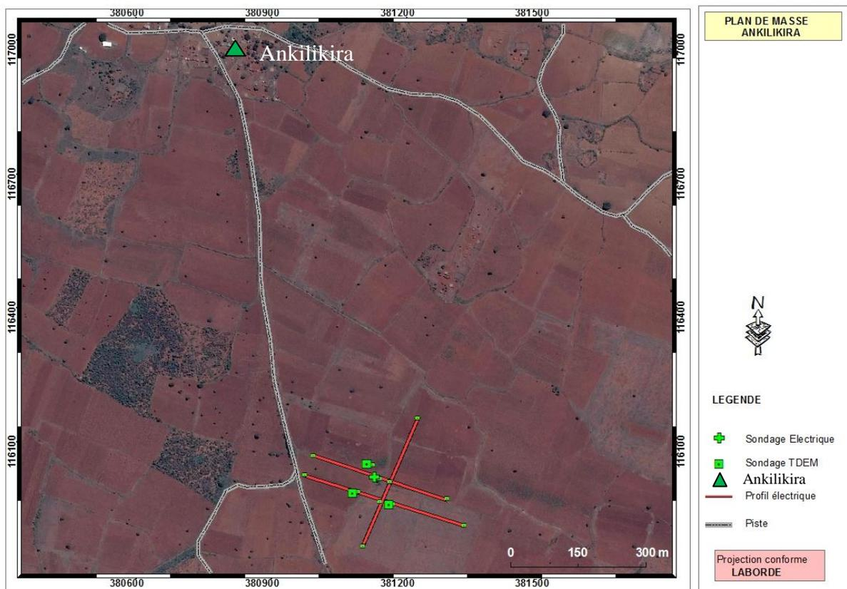
**Figure 53: Plan de masse des emplacements des mesures géophysique**
