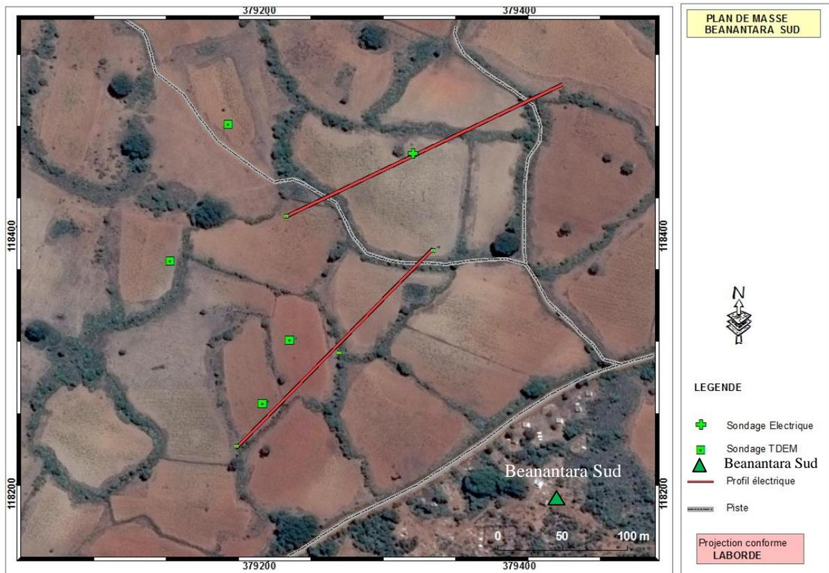
**Figure 49: Plan de masse des emplacements des mesures géophysiques**
