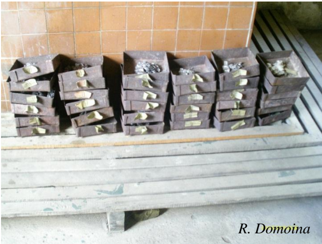
Minerai de graphite après flottation
