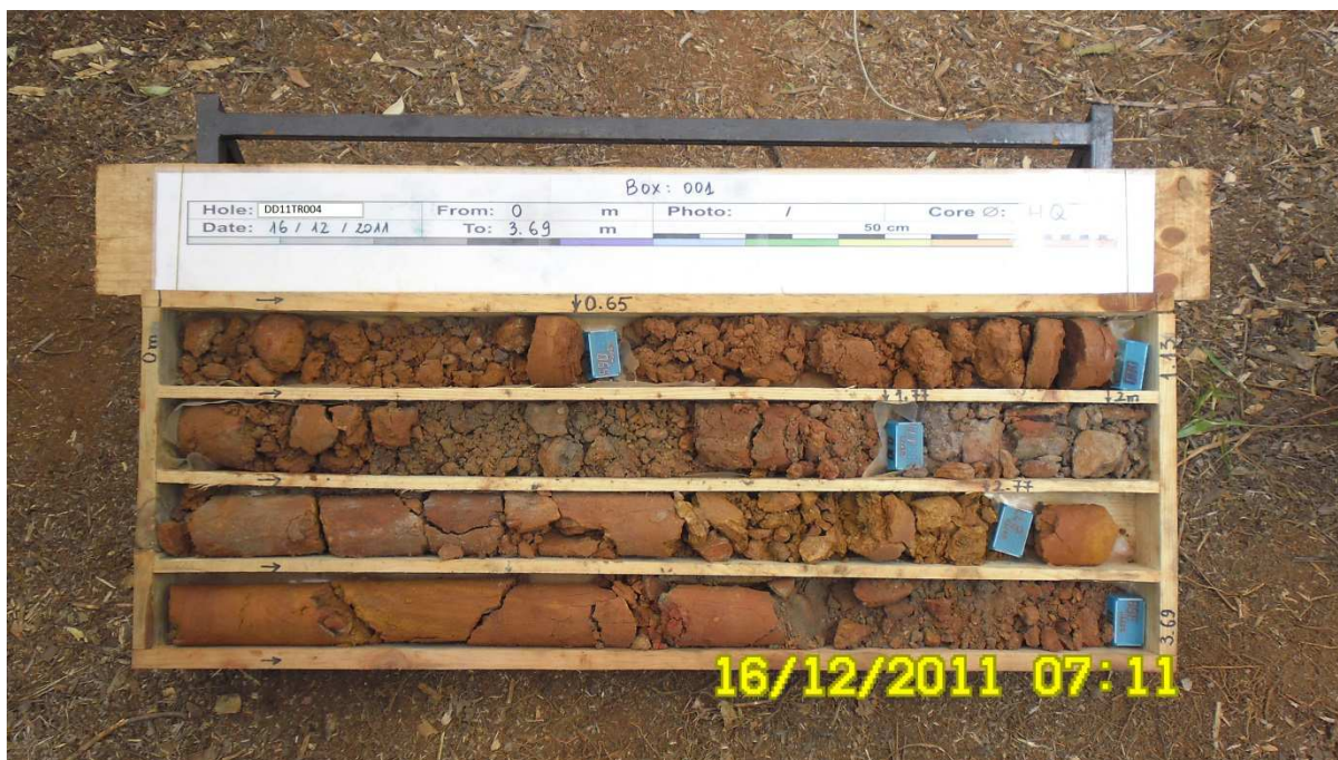
Photo10 : Carottes de forage du DD11TR004 0 à 4 m de profondeur
