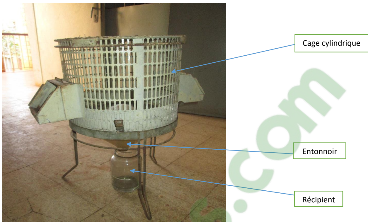
Figure 3. Cage à métabolisme individuelle pour récolter l'urine émise par le rat
