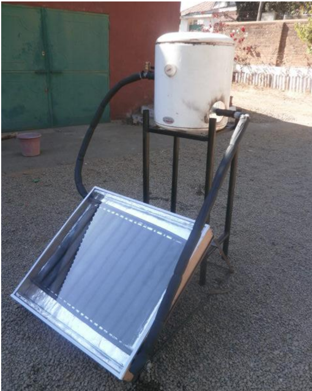
Photo 18: Le Chauffe-eau solaire à thermosiphon à capteur plan vitré
