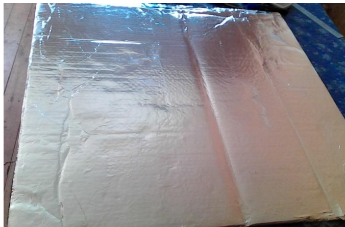
Photo 9: Surface réfléchissante en dessous du capteur
