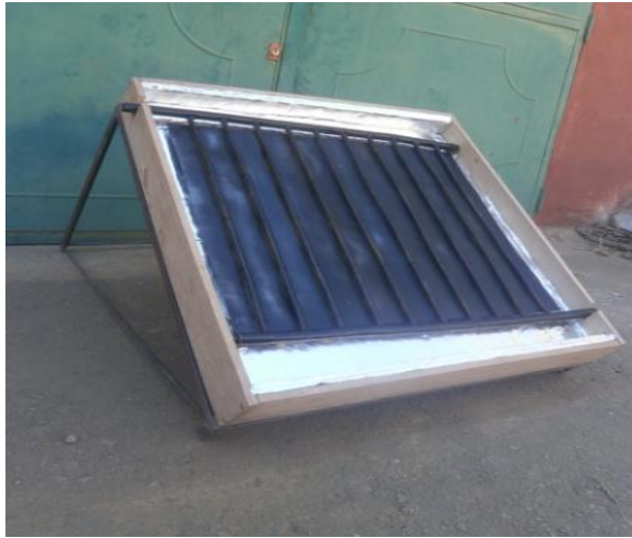
Photo 13: Mise en place des éléments du capteur dans le coffre
