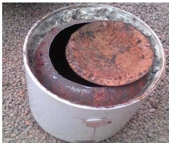
Photo 14: Découpage du chauffe-eau électrique
