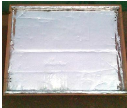
Photo 12: L'isolation et la surface absorbante
